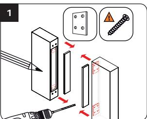
Découpez dans le profilé la surface déterminée qui va accueillir la ventouse CZ3000 et son armature. Faites les marquages de la position des vis de fixation puis percez la surface au niveau de la fixation de la ventouse pour faciliter le vissage. ensuite, fixez les pattes de mise en affleurement (attention les vis de fixation ne sont pas fournies).
