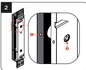
Passez vos fils, et branchez la ventouse. A l'aide de la clé fournie dévisser les 2 écrous de blocage (1). Puis avec une clé 6 pans, ajuster la contre-plaque à 2 mm de la ventouse. Ressérer ensuite les 2 écrous de blocage (2).
