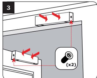
Testez le fonctionnement de la ventouse et de la contre-plaque puis fixez-les sur le kit du dormant et de l'ouvrant. Pour finaliser l'installation, vissez la partie supérieure des kits.
