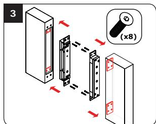
Testez le fonctionnement de la ventouse et de la contre-plaque puis fixez-les aux pattes de mise en affleurement.
