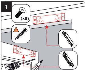
Faites les marquages des entraxes de la ventouse sur le dormant et de la contre-plaque sur l'ouvrant puis percez la surface pour faciliter le vissage. **Important :** le kit de mise en saillie doit se poser en horizontal ou en vertical sur une porte s'ouvrant vers l'intérieur.
