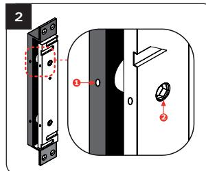
Branchez la ventouse, puis à l'aide de la clé fournie dévissez les 2 écrous de blocage (1). Puis avec une clé 6 pans, ajustez la contre-plaque à 2 mm de la ventouse. Ressérez ensuite les 2 écrous de blocage (2).
