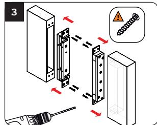
Testez le fonctionnement de la ventouse et de la contre-plaque puis fixez-les (attention les vis de fixation ne sont pas fournies).
