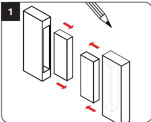
Découpez dans la surface déterminée une partie creuse qui va accueillir la ventouse CZ3000 et son armature. Puis faites les marquages de la position des vis de fixation. Percez la surface au niveau des entraxes de la ventouse et de son armature pour faciliter le vissage. Percez le fond de la surface découpée afin de passer les câbles.
