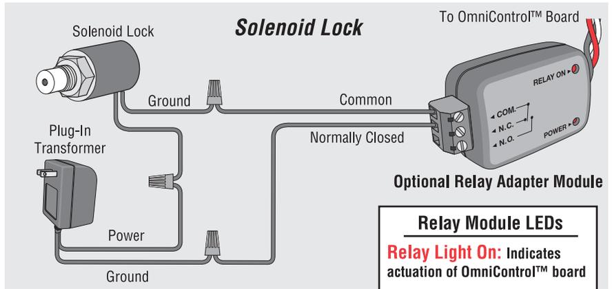
**Relay Module LEDs**
