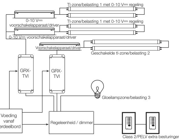
**Opmerking:** Bij gebruik van een regeleenheid is er voor elke 0-10 V--- tl-zone een GRX-TVI nodig. (Als voorbeeld wordt een 3-zone regeleenheid met twee tl-zones en één gloeilampzone weergegeven.)
