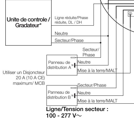
Le L1/H1 est la Ligne d'entrée/sous tension qui alimente la Ligne commutée. Sortie sous tension à la charge. Utiliser une tension de 100 - 277 V~.
