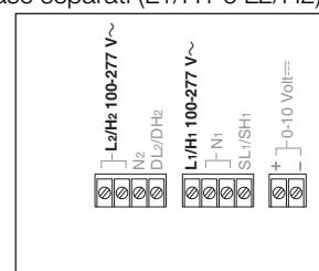
Il cablaggio in Classe 2/PELV, 0-10 V== da un reattore/driver all'interfaccia GRX-TVI deve essere separato dal cablaggio di alimentazione. Inserire i fili Classe 2/PELV attraverso i fori pretagliati accanto alle morsettiera 0-10 V==. La barriera assicura una separazione flessibile e un facile accesso ai morsetti. Assicurarsi che tale barriera sia in posizione una volta terminata l'installazione.
