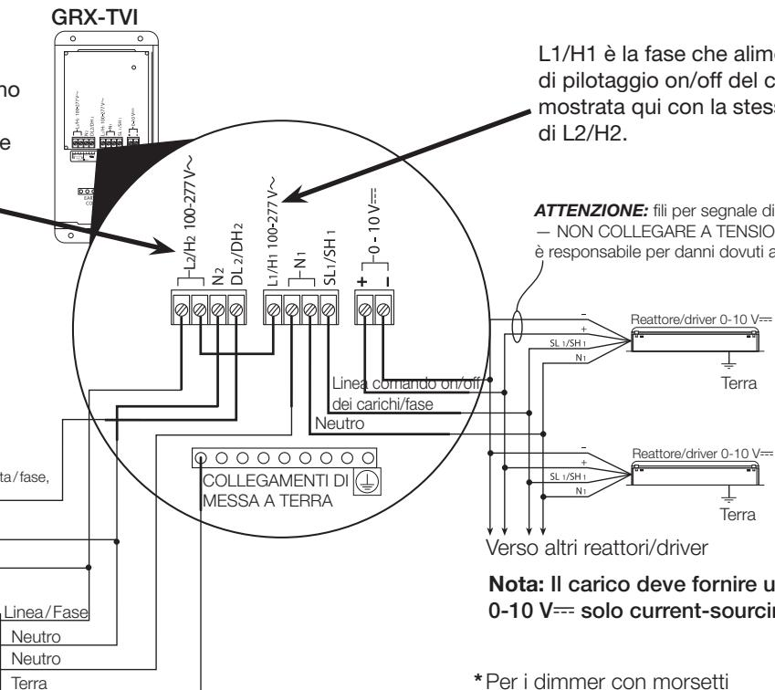
L1/H1 è la fase che alimenta l'uscita di pilotaggio on/off del carico, mostrata qui con la stessa tensione di L2/H2.
