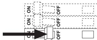
注：可能提供了多路电源馈线。接线前，确保所有馈线都已断开。
