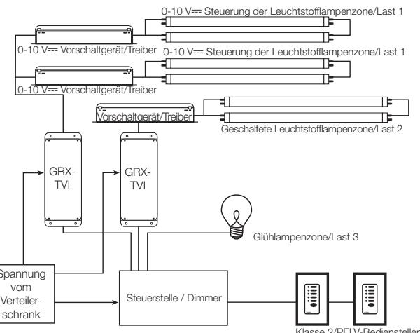
**Hinweis:** Bei Benutzung einer Steuerstelle wird für jede 0-10 V--- Leuchtstofflampenzone ein GRX-TVI benötigt (als Beispiel ist eine 3-Zonen-Steuerstelle mit zwei Leuchtstofflampenzonen und einer Glühlampenzone dargestellt.)
