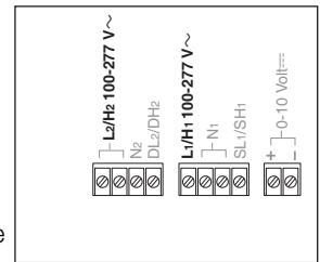
El cableado Class 2/PELV, 0-10 V--- desde el balastro/driver hasta el GRX-TVI debe estar separado del cableado de alimentación. Coloque los cables Class 2/PELV en el orificio precortado adyacente a los conectores de 0-10 V---. La barrera asegura la separación y, al ser flexible, permite el acceso a los terminales. La barrera debe ser colocada cuando la instalación esté completa.
