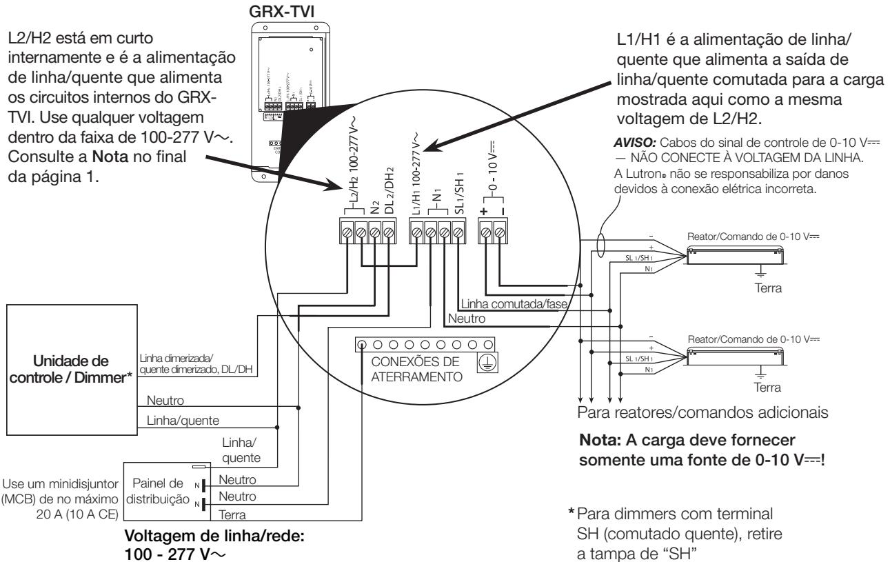
\* Para dimmers com terminal SH (comutado quente), retire a tampa de "SH"
