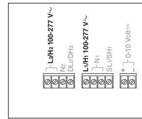
**Hinweis 2:** Die Speisespannung der Steuerstelle (DL2/DH2) und der L2/H2-Klemmen im GRX-TVI müssen an die gleiche Phase angeschlossen werden!
