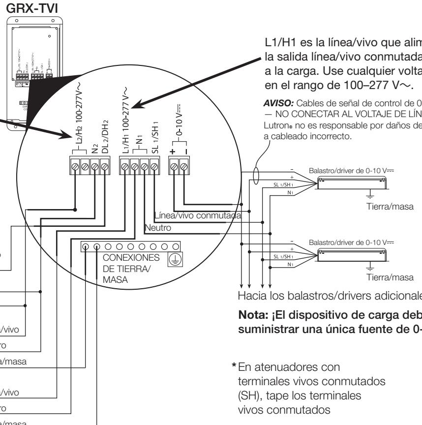
L1/H1 es la línea/vivo que alimenta la salida línea/vivo comutada a la carga. Use cualquier voltaje en el rango de 100-277 V~.
