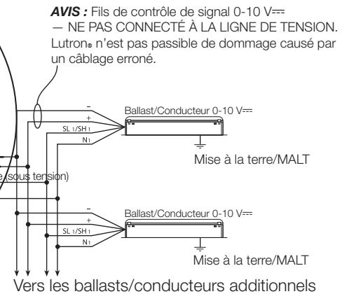
\*Pour les gradateurs avec une borne de raccordement SH (sous tension), s'il vous plaît capuchonnez le «SH».
