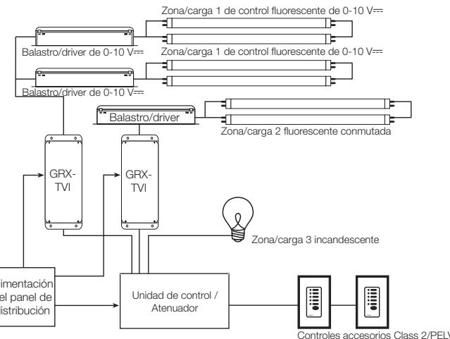
**Nota:** Cuando se usa una unidad de control, se necesita una interfaz GRX-TVI para cada zona fluorescente de 0-10 V---. (Se muestra como ejemplo una unidad de control de 3 zonas con dos zonas fluorescentes y una zona incandescente).
