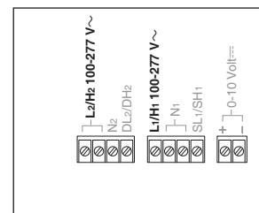
从镇流器/驱动器连接到 GRX-TVI 上的 Class 2/PELV, 0-10 V-- 接线必须与电源接线分开。将 Class 2/PELV 接线从 0-10 V-- 接线端柱旁边的穿线孔中穿入。挡板可确保将两者分开，而且不影响接线端子的使用。安装完成时必须装上该挡板。
