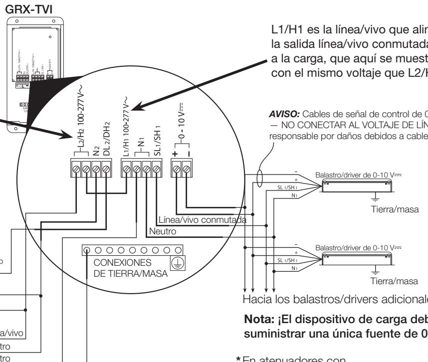
L1/H1 es la línea/vivo que alimenta la salida línea/vivo comutada a la carga, que aquí se muestra con el mismo voltaje que L2/H2.
