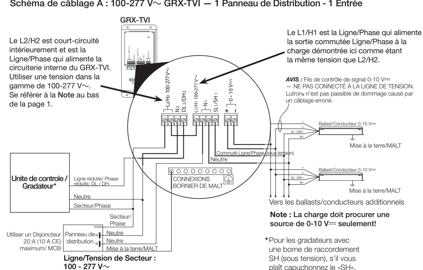
Le L1/H1 est la Ligne/Phase qui alimente la sortie commutée Ligne/Phase à la charge démontrée ici comme étant la même tension que L2/H2.
