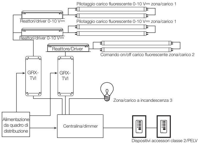
**Nota:** Quando si usa una centralina, ogni zona dimmerabile con carichi fluorescenti 0-10 V $\text{---}$  necessita di un'interfaccia GRX-TVI (nell'esempio è mostrata una centralina a 3 zone di cui due con carichi fluorescenti e una a incandescenza).
