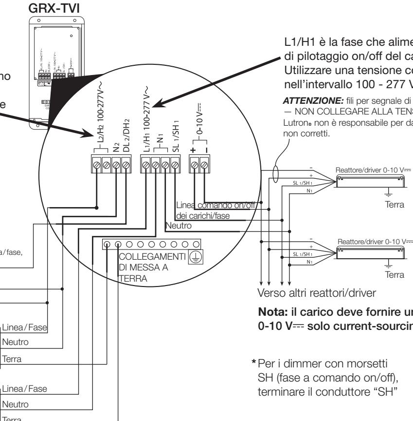
L1/H1 è la fase che alimenta l'uscita di pilotaggio on/off del carico.
