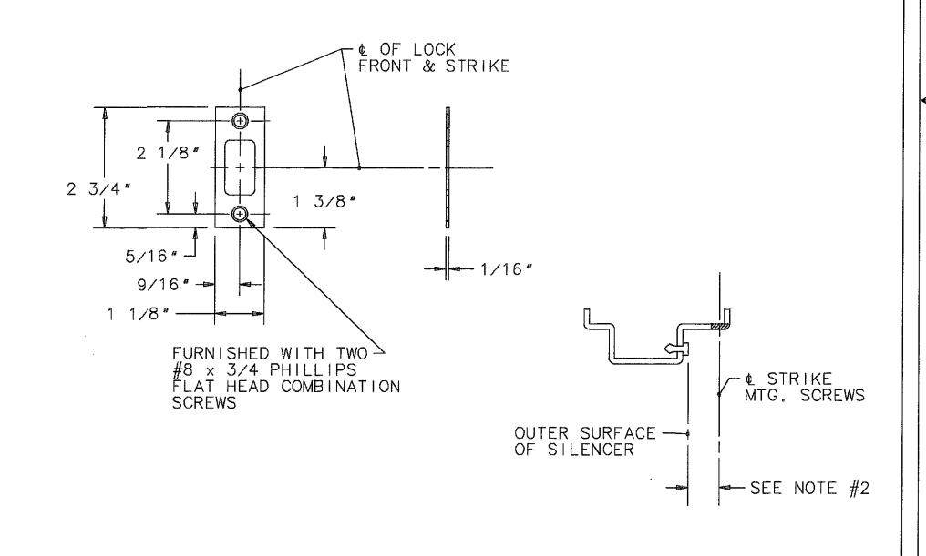
WHEN DOOR SILENCERS ARE USED ON DOOR FRAME, LOCATE CENTERLINE OF STRIKE FROM SURFACE OF DOOR SILENCER AS SHOWN.
