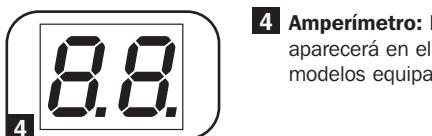
**4 Amperímetro:** La corriente eléctrica total utilizada por el PDU aparecerá en el medidor digital en amperes (aplica solo para modelos equipados con un amperímetro).
