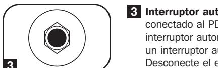
**3 Interruptor automático:** Si la corriente consumida por el equipo conectado al PDU excede la máxima capacidad de corriente, el interruptor automático disparará para evitar posibles daños. Cuando un interruptor automático dispara, su émbolo se extiende. Desconecte el equipo en exceso y permita que el interruptor automático se enfríe un minuto antes de presionar el émbolo para restablecer el interruptor automático.
