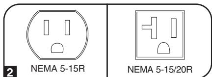
**2 Salidas (Varía por Modelo):** Durante la operación normal, las salidas distribuyen energía CA al equipo conectado.
