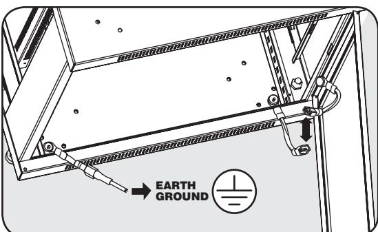
**Advertencia:** Conecte cada rack a tierra por separado. No use el rack sin una conexión a tierra.
