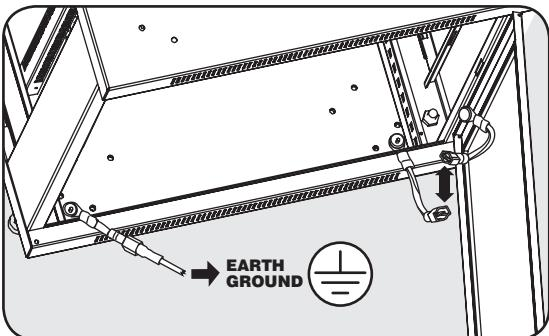
**Attention : Chaque armoire doit être mise à la terre séparément. N'utilisez pas l'armoire avant d'avoir effectué le branchement à la terre.**
