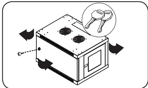
Cada panel lateral se asegura usando una palanca en "L" en el lado interno del gabinete.
