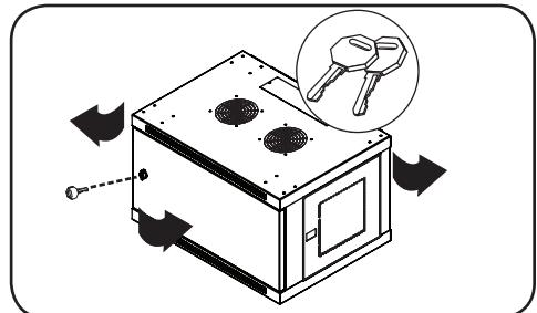
Каждая из боковых панелей запирается при помощи Г-образного рычажка с внутренней стороны шкафа.
